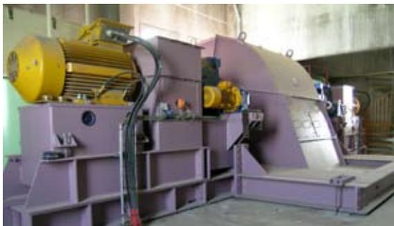
Tête d'élévateur gros débit (1600 m<sup>3</sup>/h, hauteur 65 m, 2x200 kW)
