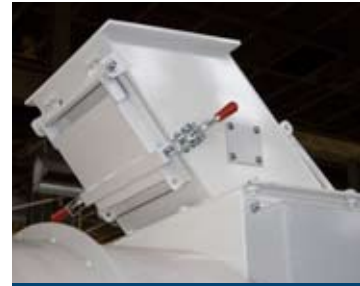
Plaque magnétique sur goulotte d'alimentation
