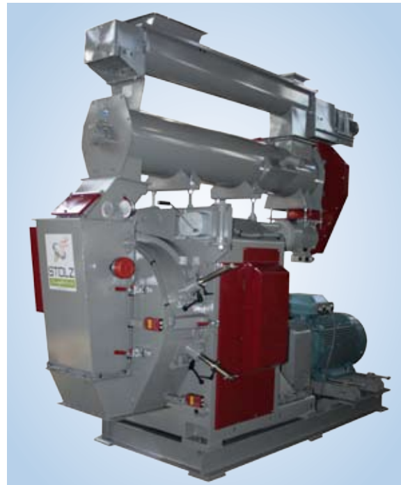
Ensemble vis d'alimentation à vitesse variable + conditionneur + presse
