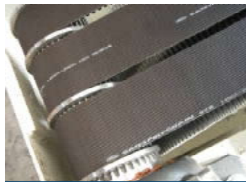
Transmission par courroies réduisant les coûts d'entretien
