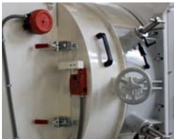
Sécurité sur portes électrique
