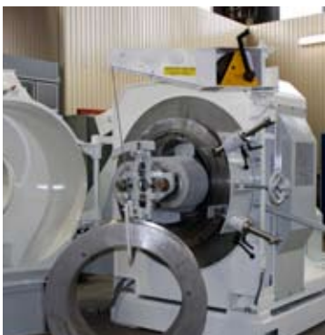
Treuil intégré pour manutention de la filière
