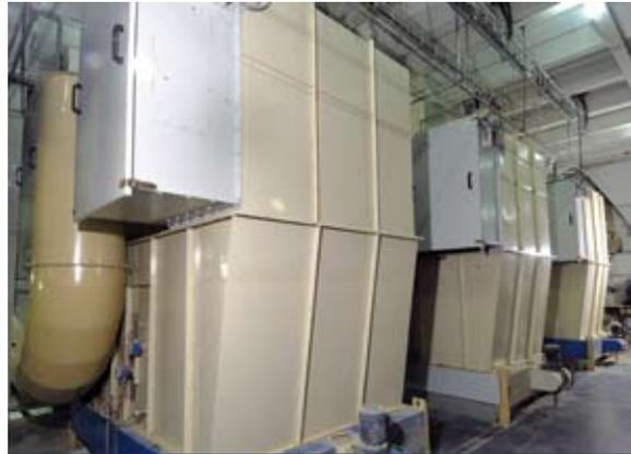
Refroidisseur-sécheur à contre-courant
