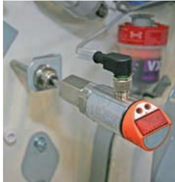
Control de temperatura en la cámara de molienda
