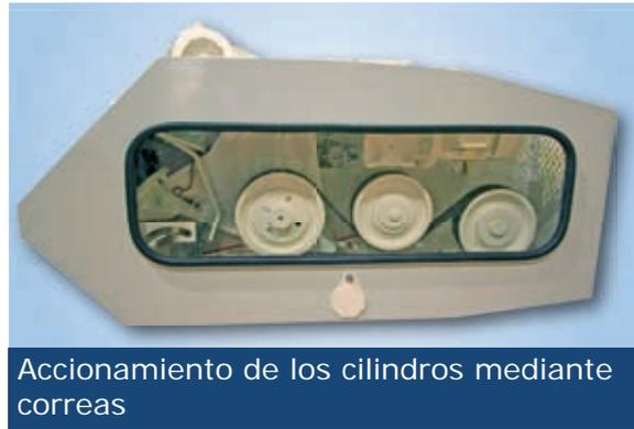
Nuestra gama de desmigadores obtiene migas con dimensiones desde 0,2 hasta 4 mm por el paso del producto granulado entre 2 cilindros.
