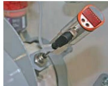
Sonda de control de las temperaturas en las cajas de cojinetes
