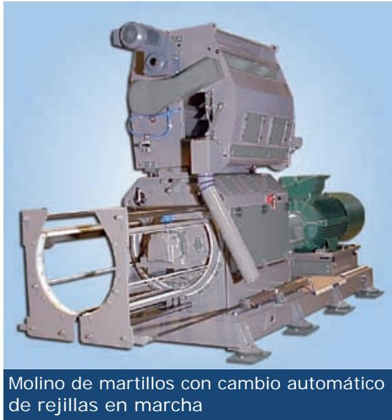
Molino de martillos con cambio automático de rejillas en marcha
