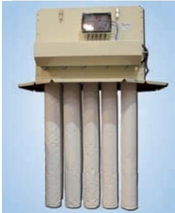
Filtro de mangas (instalación en transporte neumático)
