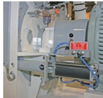
Extracción neumática de las rejillas
