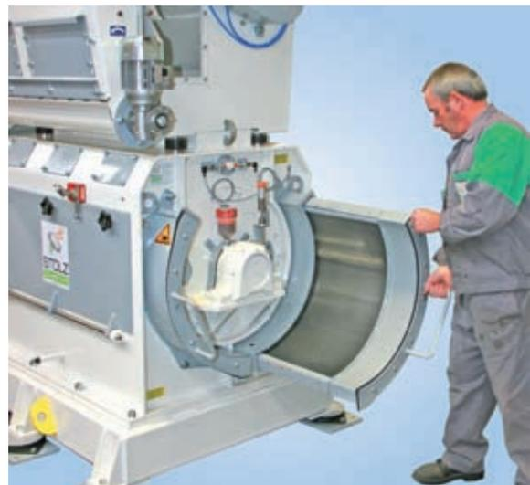
Cambio manual de las rejillas en operación con carter de seguridad
