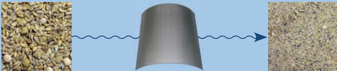
Premezcla alimento para peces -> molido con rejilla Ø 0.8 mm a 3000 rpm
