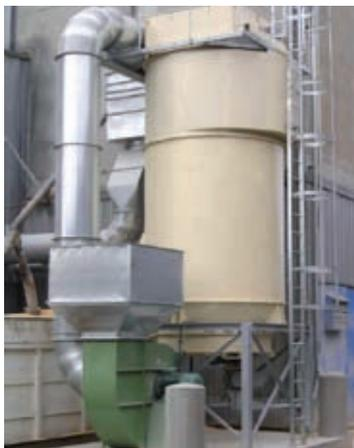
Ciclofiltro con recogida por transporte neumático
