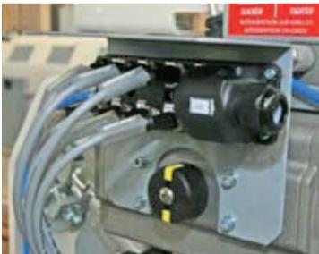
Repartidor para una conexión rápida al DCS
