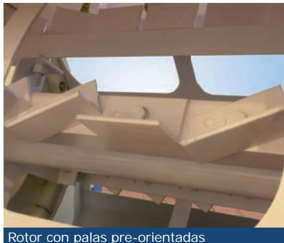
Rotor con palas pre-orientadas
