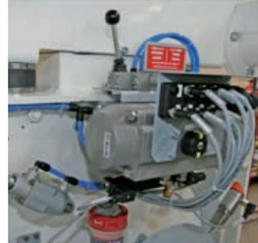
Actuador rotativo para la orientación del panel de alimentación
