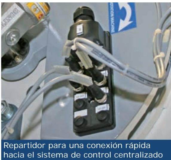
Repartidor para una conexión rápida hacia el sistema de control centralizado
