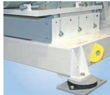
Estructura soporte del motor - base - contacto antivibratorio
