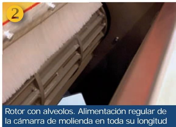
Rotor con alveolos. Alimentación regular de la cámara de molienda en toda su longitud
