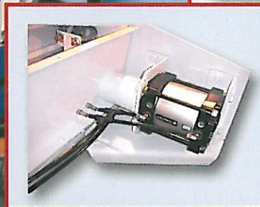
Extracción con accionamiento neumático
